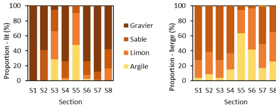
Figure 13. Proportions du contenu en argile, en limon, en sable et en graviers pour les échantillons du lit (Gauche) et des berges (Droite) de chacune des sections types.
