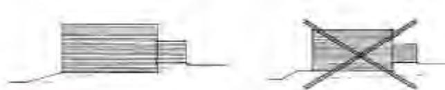
Figure 16. Constructions implantées de manière à respecter la topographie naturelle du terrain et à minimiser les travaux de modification susceptibles de perturber le milieu.
